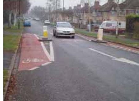
**Figure 24** Deux rétrécissements de la chaussée aux configurations différentes
